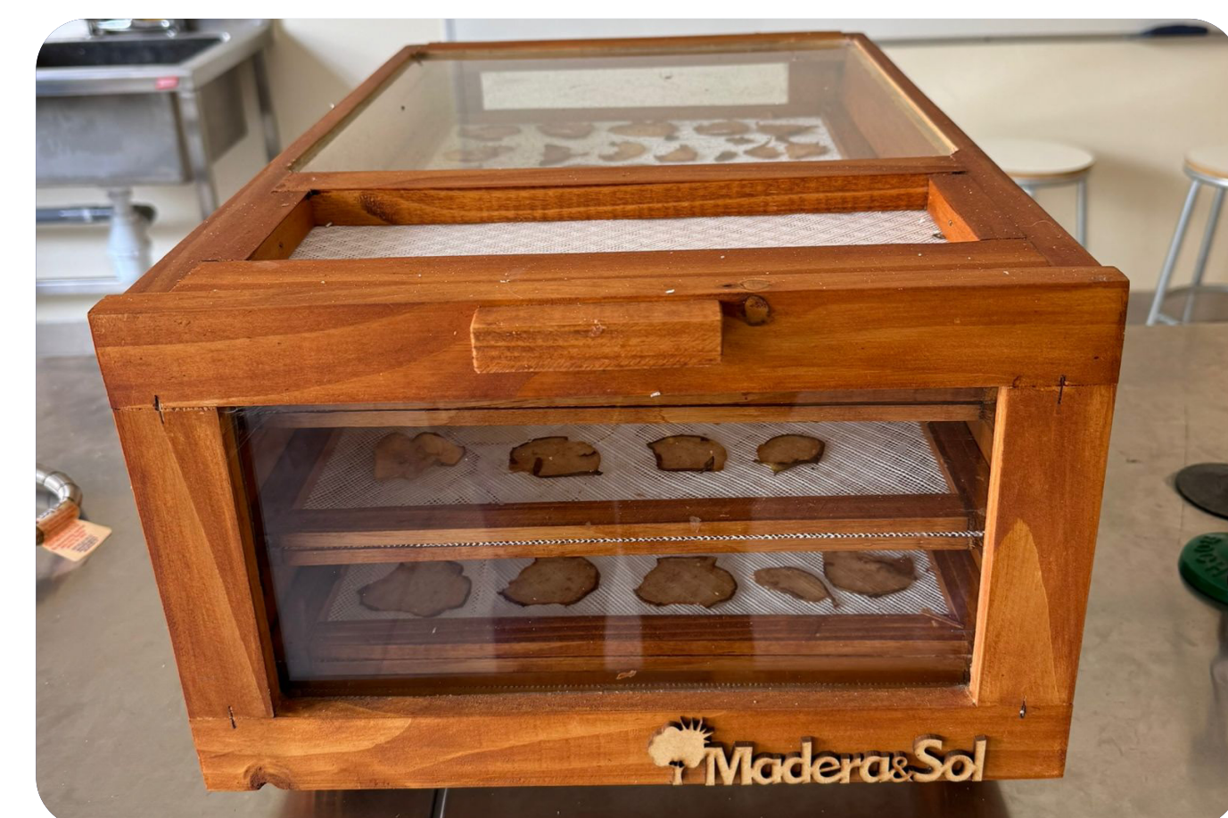
Deshidratador solar provisto de bandejas de mallas y revestida de vidrios.
