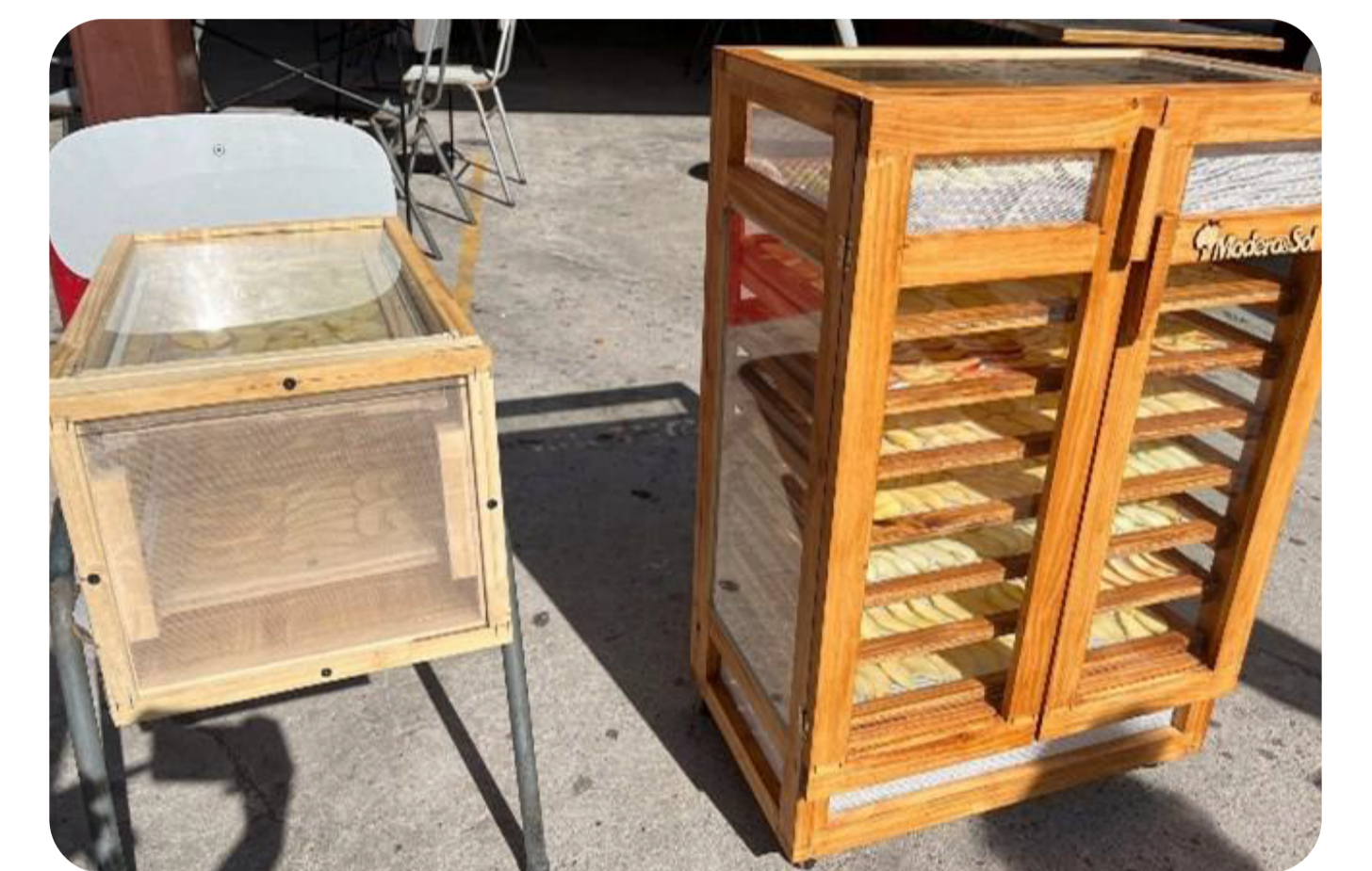
Deshidratador solar provisto de bandejas de mallas y revestida de vidrios.
